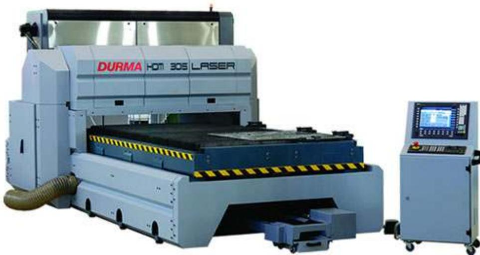
Este equipo realiza cortes en metal dirigido por computadora y mediante un haz de luz direccionado, posibilitando el corte de piezas en serie y de acuerdo al diseño establecido, lo que permite no solo la reducción de los costos mediante la producción interna, sino que también agiliza el proceso reduciendo los tiempos y ampliando la capacidad de producción.
