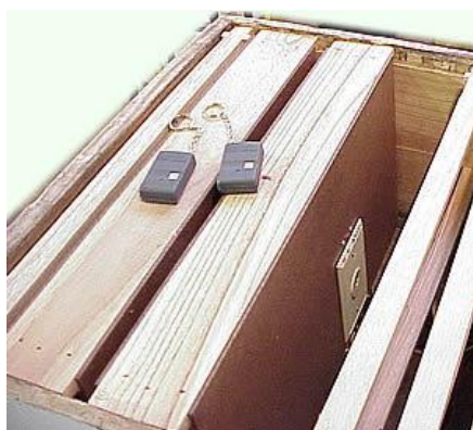
Foto N° 12 (izq.): Colmena equipada con una caja para la central y otra para la batería.
