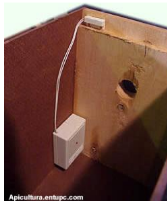
Foto N° 12 (izq.): Colmena equipada con una caja para la central y otra para la batería.
