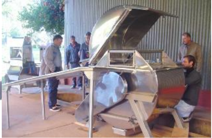
Foto N° 9: Extractor de miel centrífugo de eje horizontal
