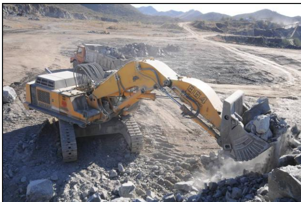
Figura 36 - Excavadores frontales, en proceso de carga de camiones internos
