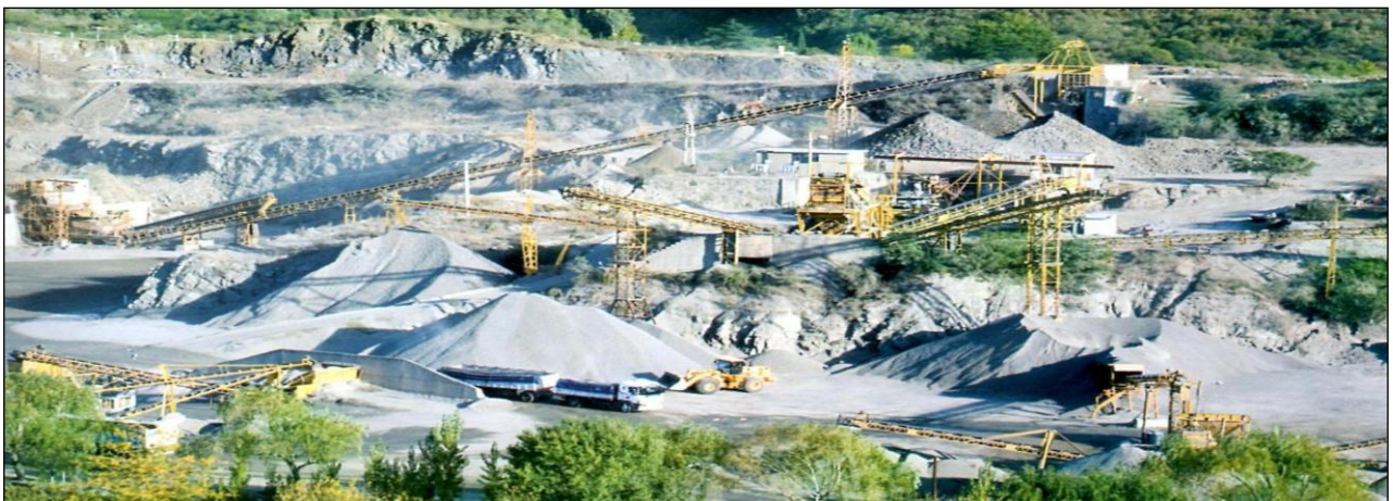
Figura 46 - Planta de Trituración - Cintas Transportadoras
