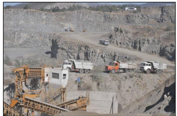
Figura 35 - Transporte interno: desde Frente de Cantera hasta Planta de Trituración
