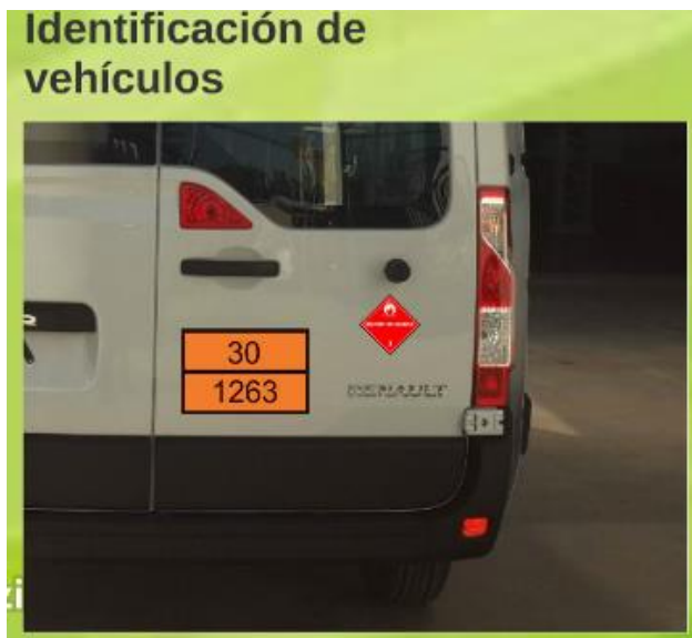
FIGURA 71- Detalle de elementos necesarios ante derrames- Identificación de vehículos.
