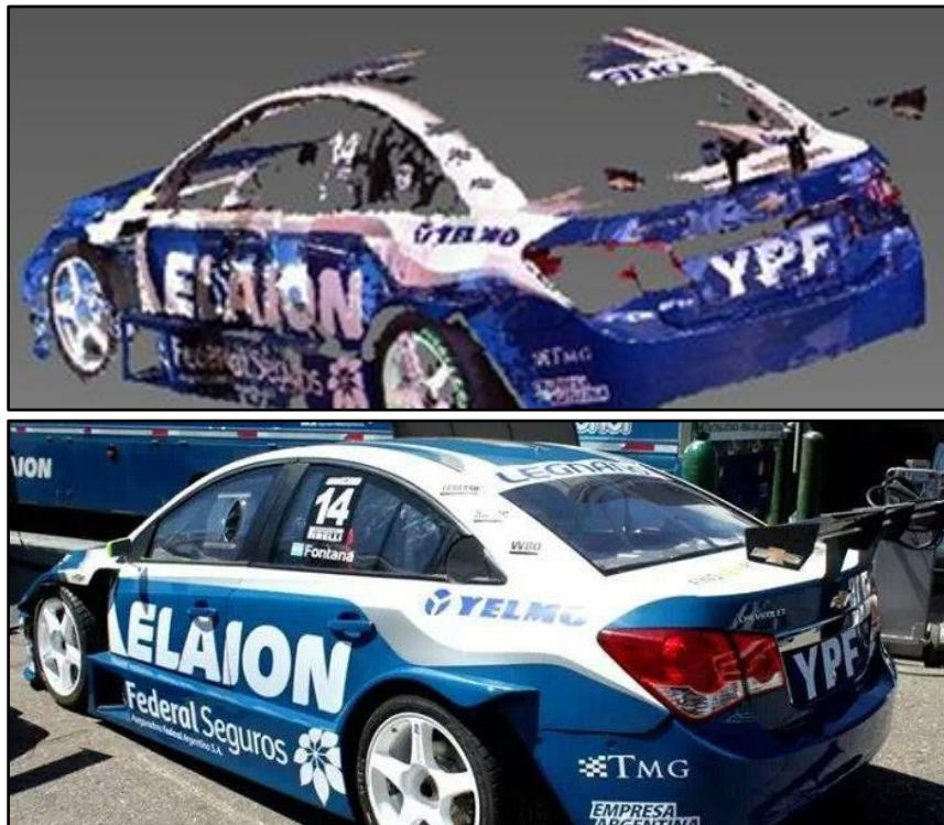
Figura 14: vista lateral posterior de la malla parcial obtenida y fotografía digital del automóvil escaneado.
