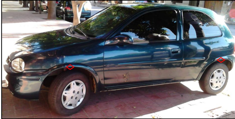
Figura 48: automóvil y puntos de referencia utilizados para las mediciones (de color rojo).
