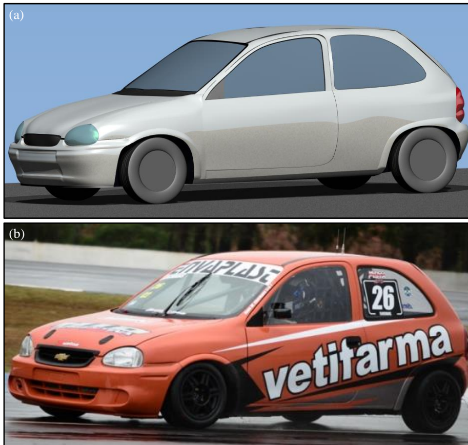
Figura 51: altura del Chevrolet Corsa: a) modelado bajado 70 mm; b) preparado para Turismo Pista Clase 2
