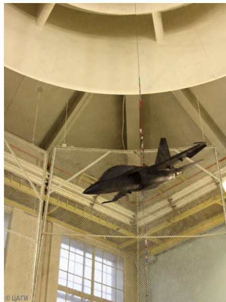
Figura 38: Ensayo de Vertical Spin de la aeronave Yak-130 en instalaciones de TsAgi.
