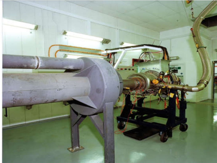
Figura 42: Instalación de ensayos de un APU.
