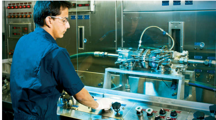
Figura 46: Instalación de ensayo Hidráulico de actuadores.
