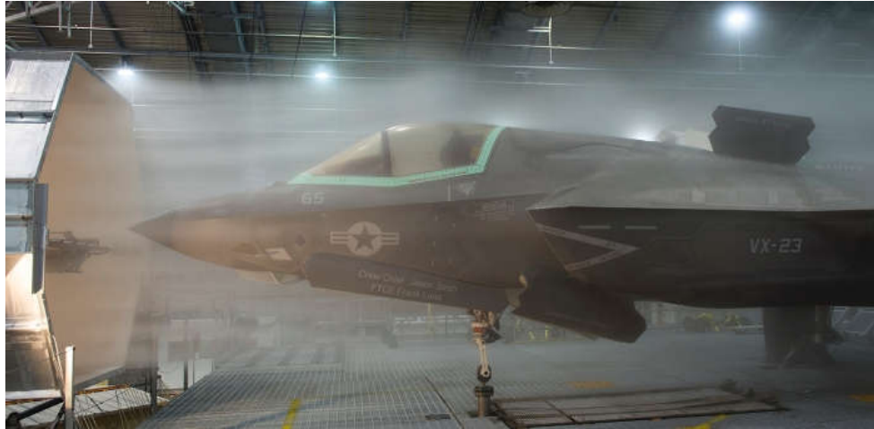
Figura 41: Ensayo de formación de hielo en aeronave F-35.
