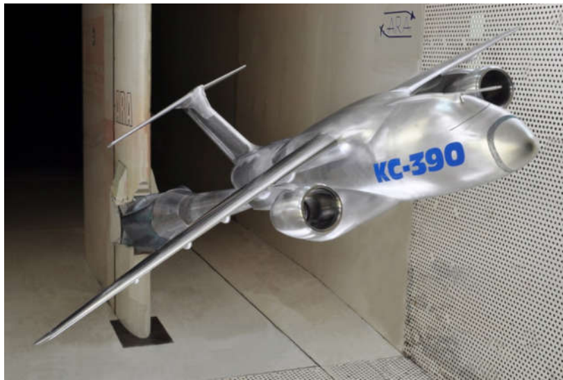
Figura 37: Modelo de túnel de viento de aeronave Embraer KC-390.
