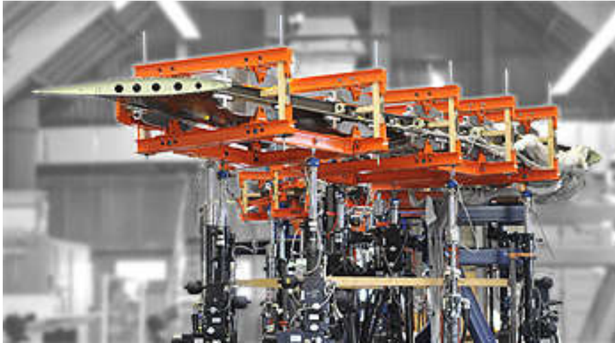
Figura 26: Ensayo de fatiga en sección alar.
