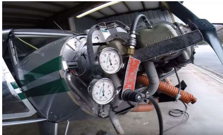
Figura 29: Ensayo de compresión en frío.
