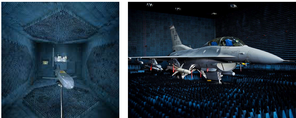
Figura 98: Bomba guiada y F-16 "Falcon" en cámaras anecóicas.
