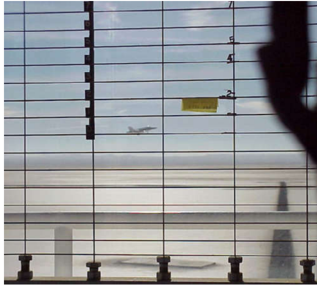
Figura 53: Grilla utilizada en el método Tower-FlyBy.
