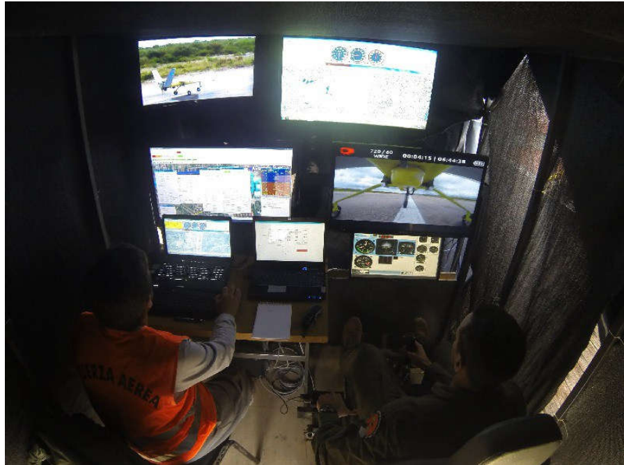
Figura 19: Estación de commando y control provisoria.
