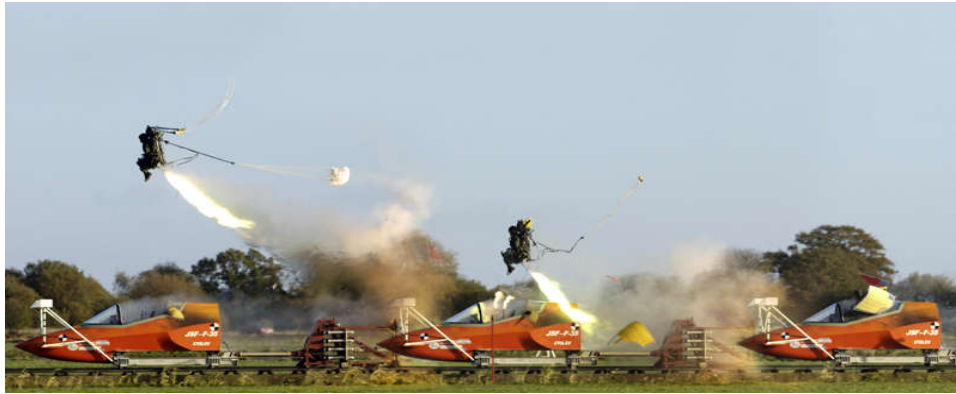
Figura 108: Secuencia de ensayo de asiento eyectable.
