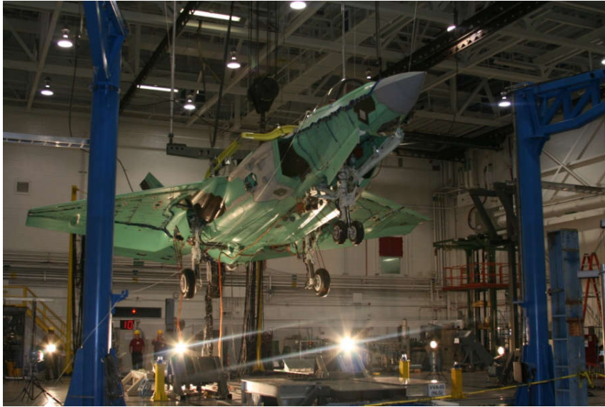
Figura 28: Ensayo de tren en prototipo de aeronave F-35.
