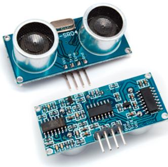
Figura 2.15: Dispositivo ultrasónico modelo HC-SR04.
