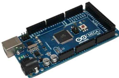
Figura 2.12: Modelo Arduino Mega 2560 R3.
