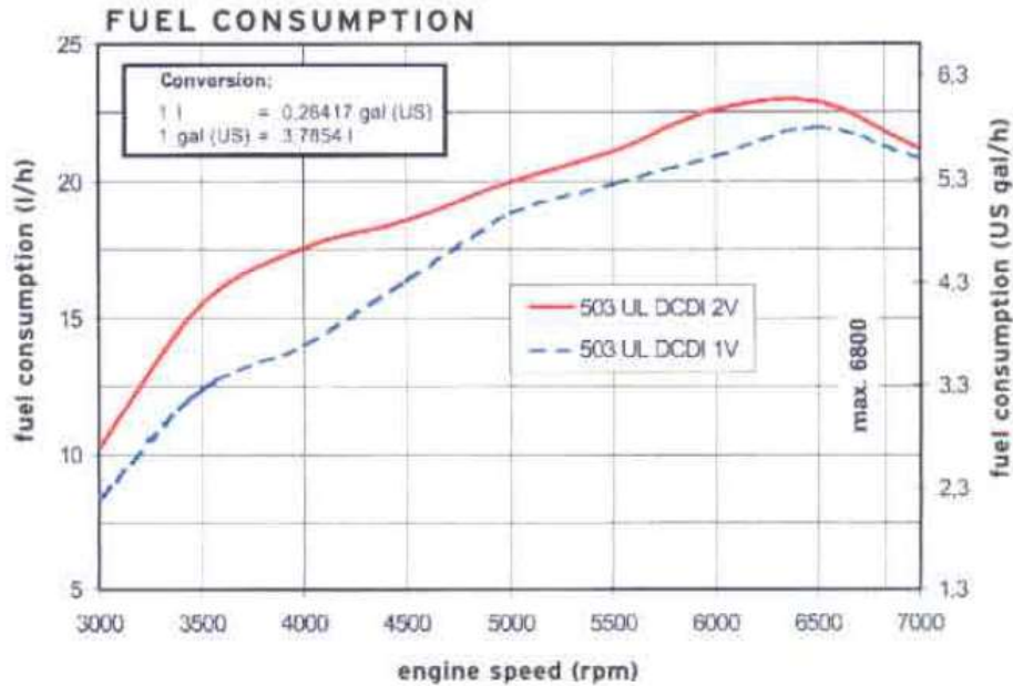
Figura 5 - Curva de consumo del motor actual Rotax 503-2V de 50Hp (fuente: Hoja de datos Rotax 503)
