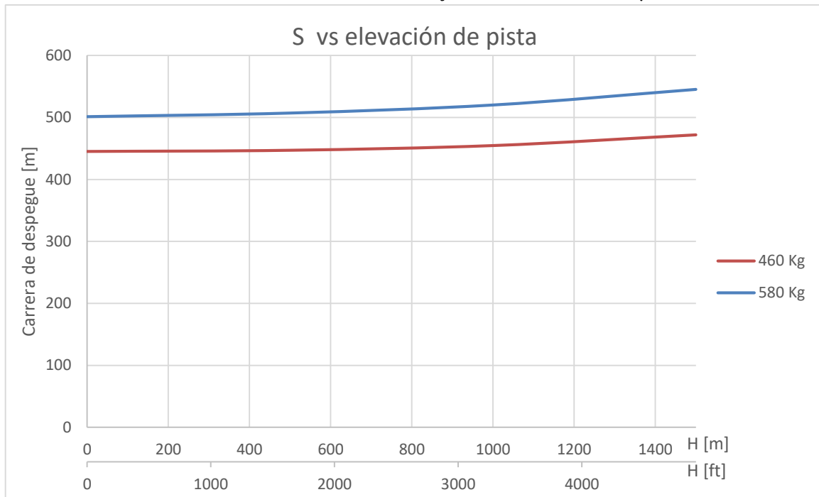
Figura 71 - variación de la distancia de aterrizaje con la elevación de pista.
