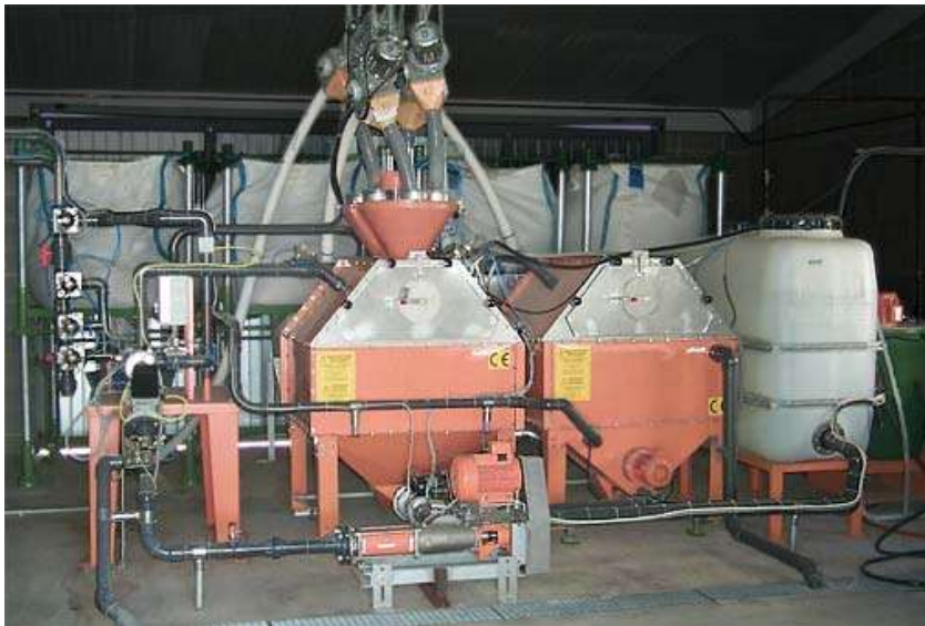
Figura 2. Sistema de alimentación líquida del ganado porcino
