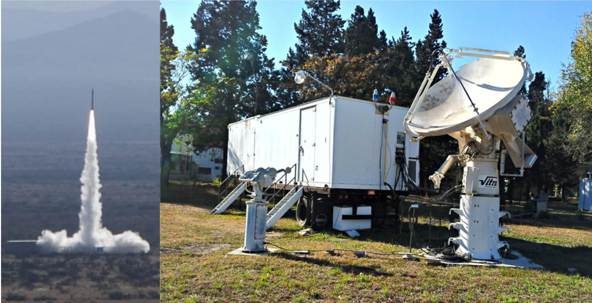
FIGURA 2.6: Radar Vitro RIR-778C. Sistema de seguimiento para un único objetivo con capacidad de maniobra.
