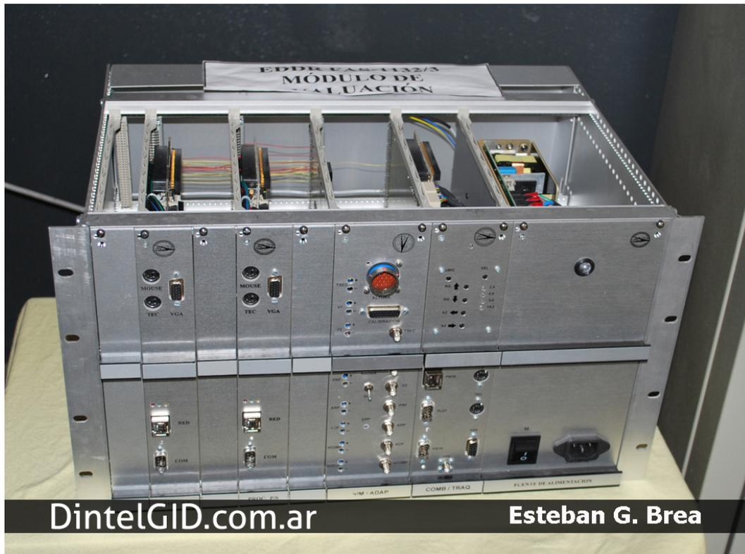
FIGURA 3.1: El subrack del sistema EDDR contiene los procesadores primario, secundario, simulador y combinador-trackeador.
