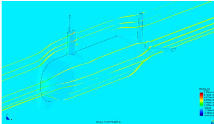
Imagen 18: Contorno de presiones y líneas de corriente en malla con capa limite
