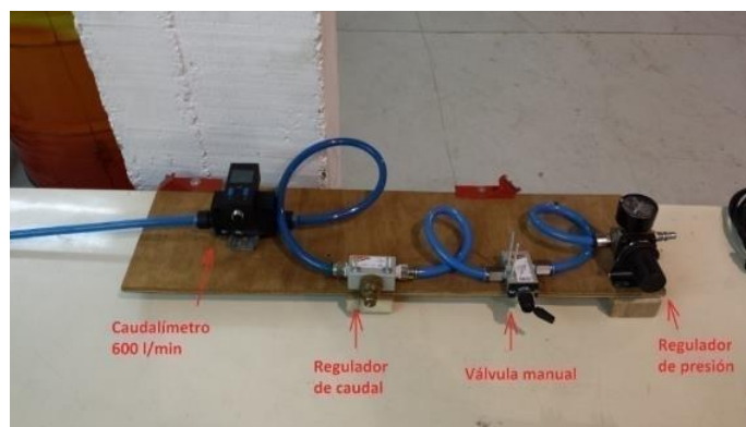
Figura 6: Tablero de control de parámetros del flujo inyectado.
