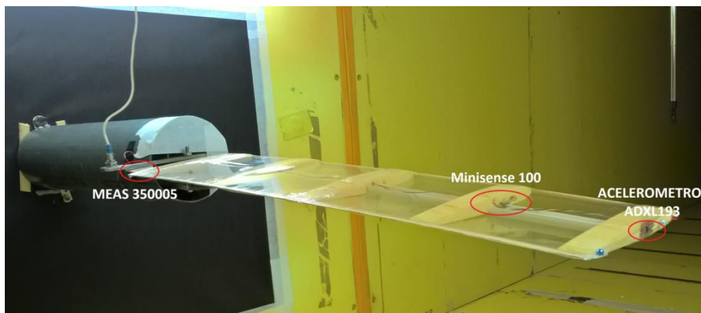
Figura 10. Posición de los sensores sobre el modelo de ala.
