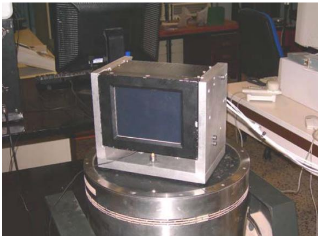
Figura 9: MFD montado sobre un dispositivo de ensayo
