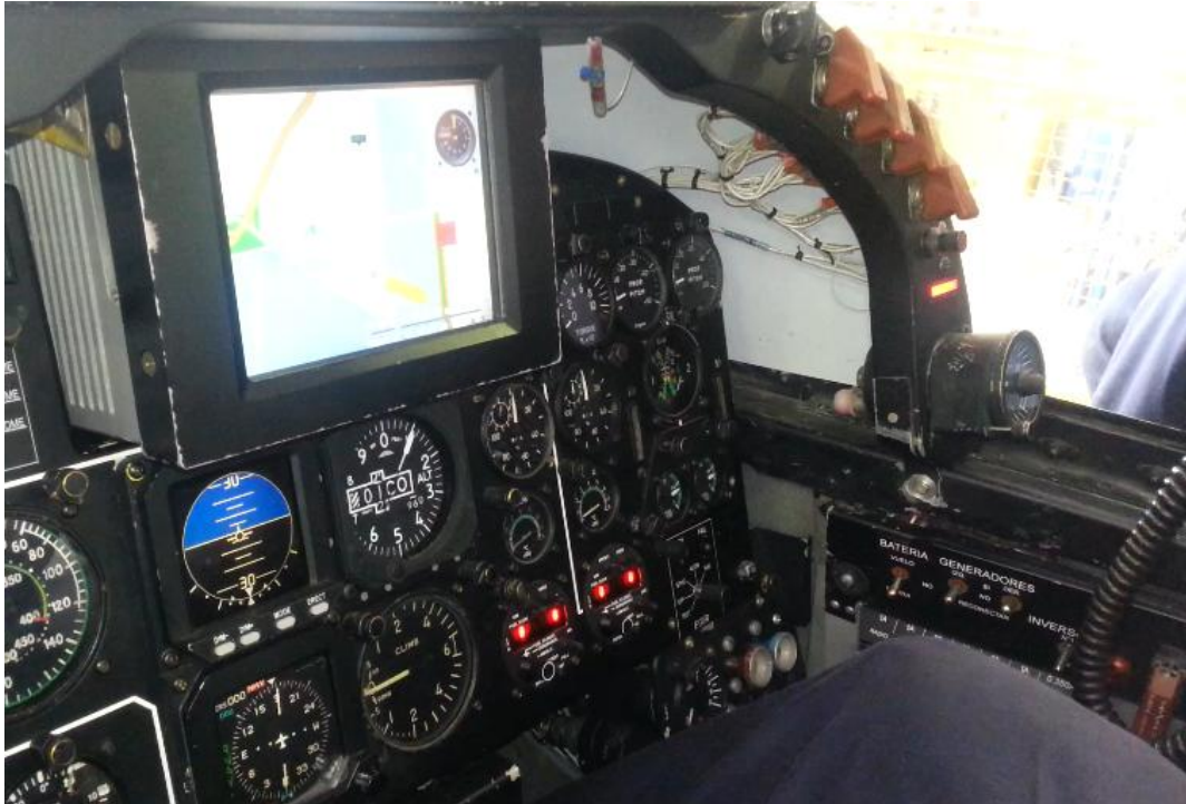
Figura 10: MFD instalado en la cabina
