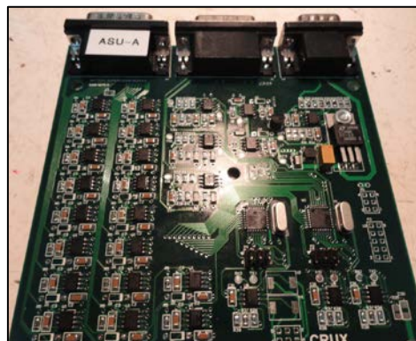
Figura 5: Sistema de medición de parámetros de batería (BMS)
