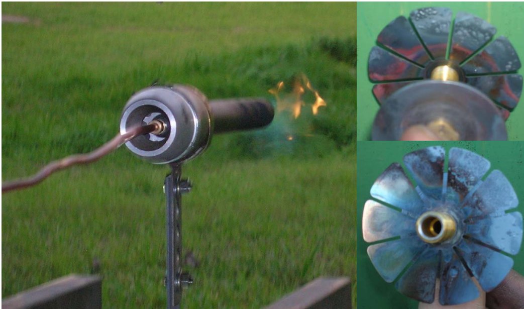
Figura 5: Pulsorreactor funcionando y Estado de las clapetas.
