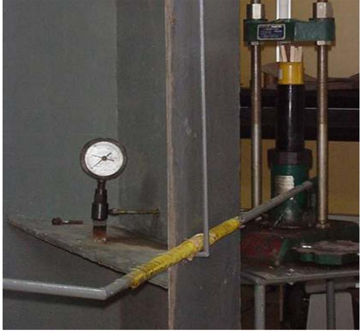
foto18 Extracción del noyo con prensa
