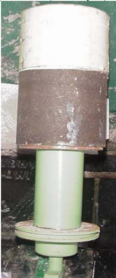
foto19 Extracción noyo cilíndrico
