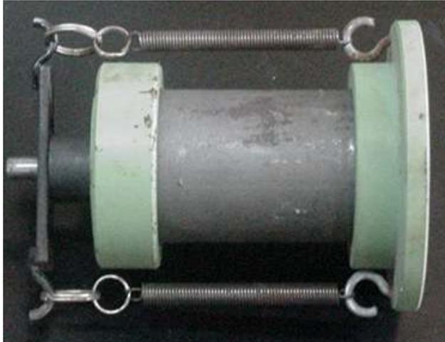
**foto8** Probeta de colado completa
