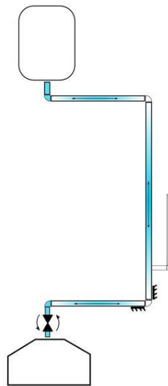
Figura 6: Medición de frecuencias naturales de fluido por golpe de ariete
