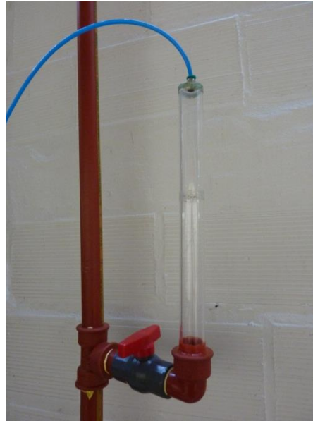
Figura 15: Dispositivo acumulador con válvula on-off de activación y conducto de presurización.
