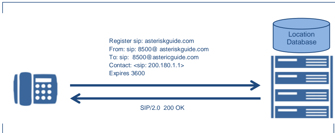
Figura 12.- Servidor de registro.
