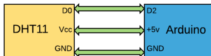
Figura 5.1: Conexión lógica entre el sensor DHT11 y la placa Arduino UNO.
