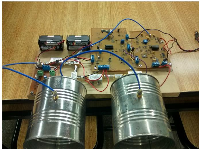
**Figura 3.94: Radar de onda continua - IMAGEN 2**
