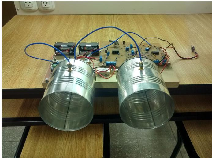
**Figura 3.93: Radar de onda continua - IMAGEN 1**
