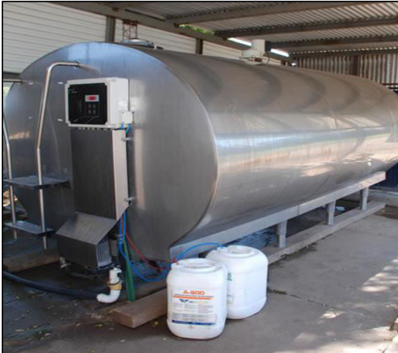
Equipamiento de la PYME. Enfriadora para almacenamiento diario de leche.
