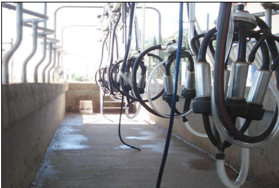
Equipamiento de la PYME. Detalle pezoneras para ordeño.
