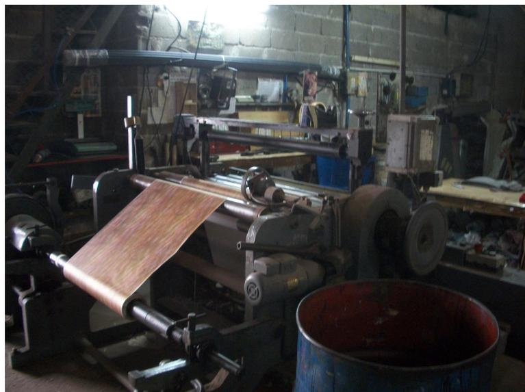
*Figura 16:* Impresora de bobinas de papel de envoltorio
