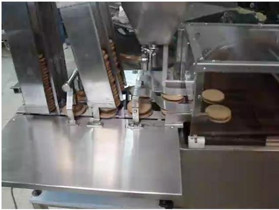
Figura 6: Máquina Armadora
