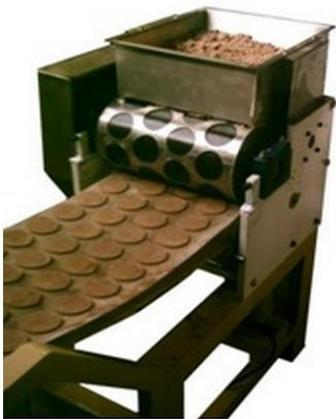
Figura 3: Máquina Rotoestampadora
