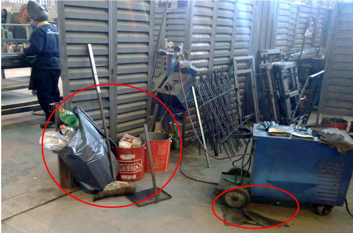
Figura N° 27 (Elementos de limpieza no tienen identificado, ni definido un sector de almacenamiento para estos).
