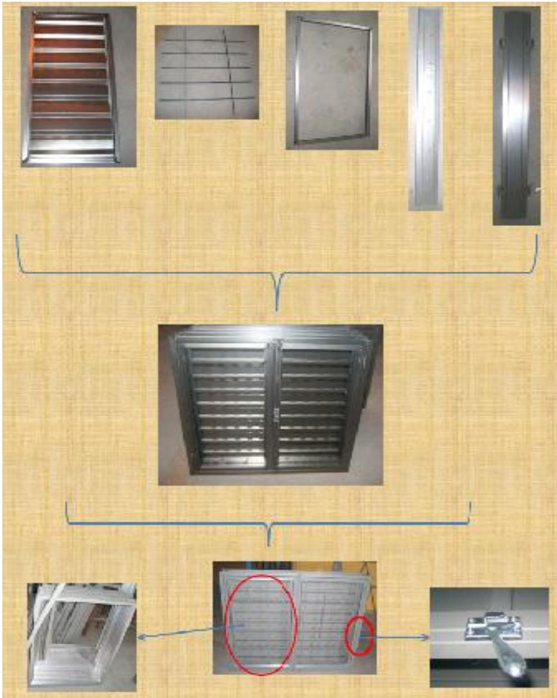
Figura N° 6 (Ensamblaje de marcos, persianas, rejas y bisagras).
