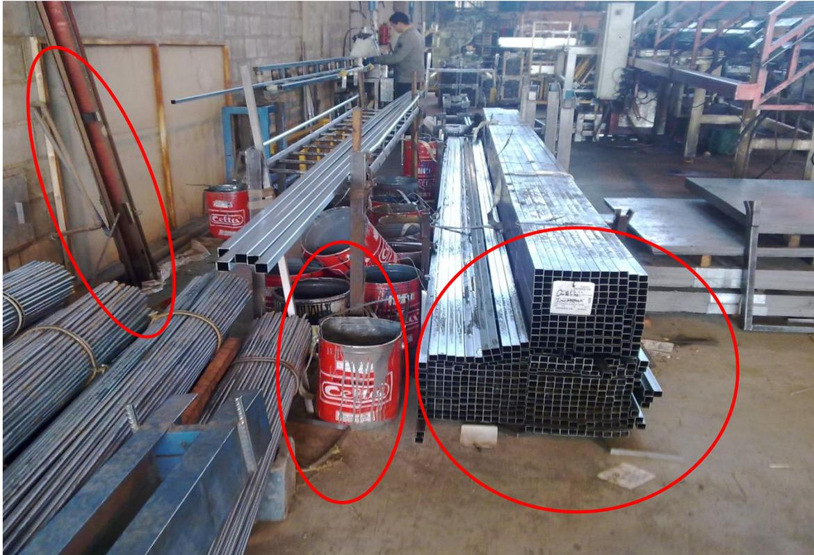
Figura N° 26 (Tarros de materiales inflamables ya utilizados en sector de materias primas, columna apoyada en la pared con riesgo de provocar accidentes)
