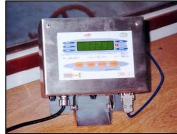
**Cabezal Electrónico Gabinete Acero
