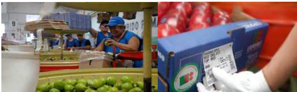
Una vez embalada la producción y colocada la etiqueta del embalador, éste la ubica en la línea y empieza a circular por la guía. En ésta, hay dos empleadas que pegan otra etiqueta con el detalle del envase, variedad y calibre. Al finalizar el recorrido de la guía, es el turno de los estibadores, quienes apilan los bultos en pallets previamente desinfectados y luego proceden a flejarlos.
