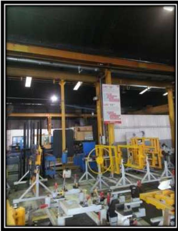
En la siguiente imagen (*Fotografía N°3*) puede apreciarse como dos carteles referentes a higiene y seguridad quedan totalmente tapados a la vista por maquinarias de trabajo. Y un tercer cartel se encuentra ubicado en un lugar muy elevado donde no puede ser apreciado correctamente.
