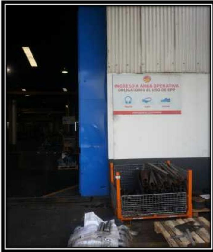
La Fotografía N°5 muestra como un cartel dispuesto en uno de los ingresos a los galpones de trabajo está mal ubicado justo detrás del sector de "scrap". Generalmente aquí puede verse una pila de materiales que tapan dicho letrero de seguridad.
