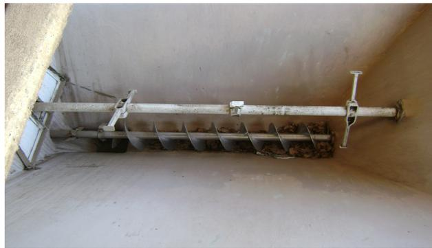
la parte inferior del Lagar se encuentra la sala de moledoras, donde se muele la uva sin lastimar el raspón, para así separarlo y poder utilizarlo para otros motivos como ser compactar caminos o en las ladrilleras. Luego de este proceso la materia prima va a unas piletas de fermentación donde se lo deja almacenar
