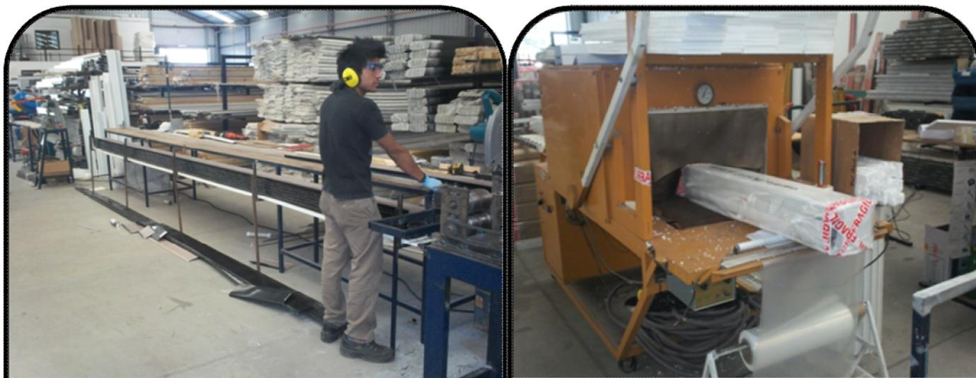
Imagen de la izquierda, se aprecia el puesto de trabajo de la sierra de corte. En la imagen de la derecha se observa la maquina embaladora.
