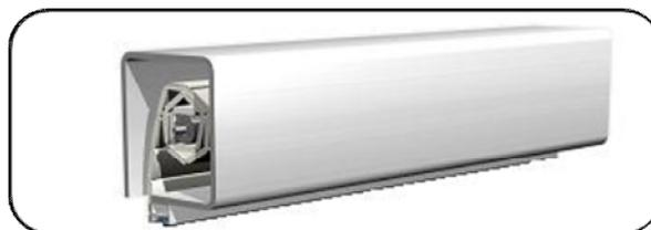
Confeccionado en doble chapa de aluminio de 2 mm de espesor cada una, rellenas entre sí con poliuretano expandido de alta densidad. Este cajón se destaca por la rotura de puente térmico en todas las uniones y por no necesitar tornillos para la unión de las tapas. A su vez, tiene los mejores resultados del mercado en pruebas de rigidez y aislamiento acústico y térmico.
