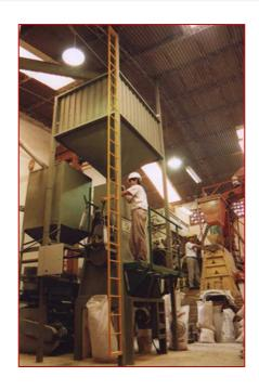
b.- Una vez que la materia prima se encuentra almacenada en las tolvas se encienden las máquinas envasadoras, posteriormente de haberlas configurado para ver el peso o tamaño al cual deben realizar el sellado de las bolsas. El funcionamiento de estas máquinas es automático (como fue explicado anteriormente en su descripción técnica), más allá de ello, se encuentra en cada máquina una persona encargada de controlar su funcionamiento y recepcionar las bolsas que son empaquetadas.
