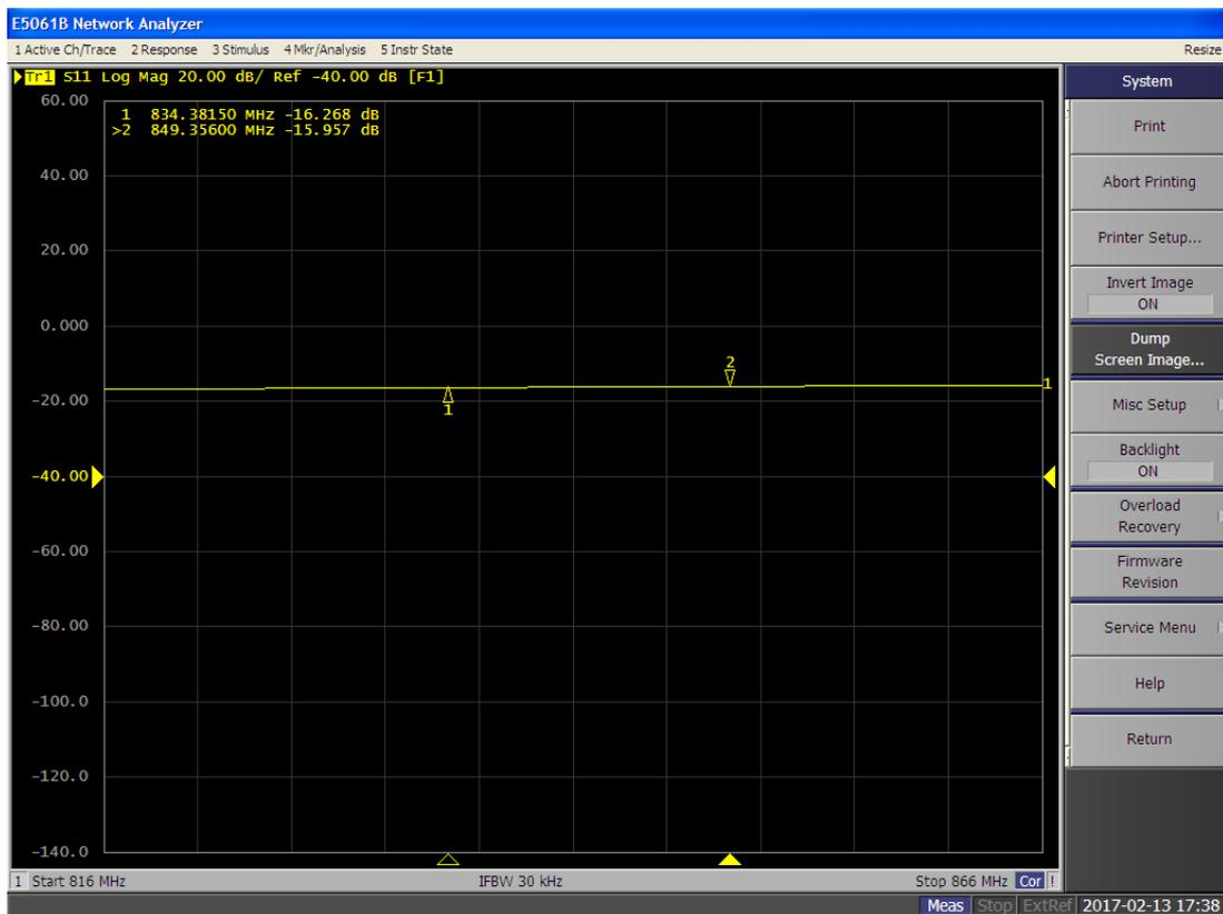
Figura 6.12: Medición de una línea de 50  $\Omega$
