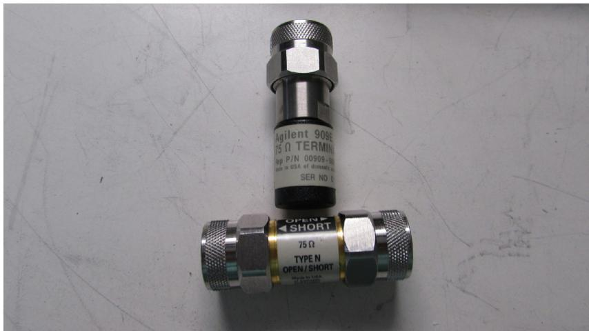
Figura 6.11: El elemento superior es la carga de 50  $\Omega$ , el elemento inferior OPEN/SHORT
