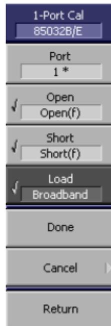
Figura 6.10: Menu calibración del puerto 1
