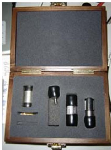
Figura 6.2: Piezas del kit de calibración Agilent
