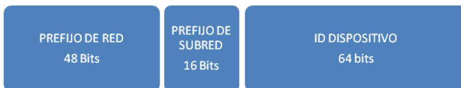
Figura 2.3.- composición de la dirección IPv6
