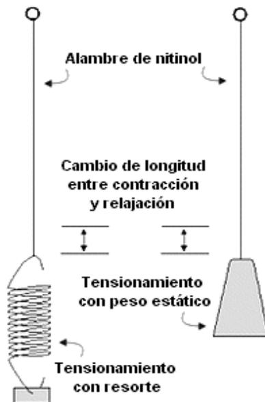
Figura 8: Ejemplo de un actuador SMA para ilustrar sobre el mecanismo Bias
