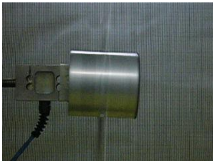
Figura 12: Pararrotor montado sobre el rodamiento basculante durante un ensayo. \beta_1 \neq \beta_2
