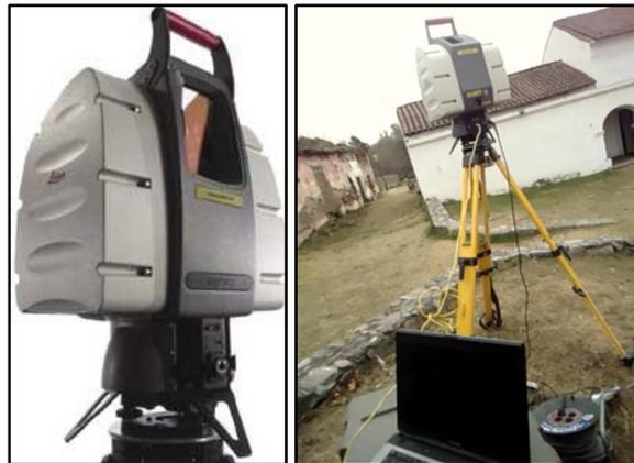
Figura 1: Escáner láser Leica HSD3000
