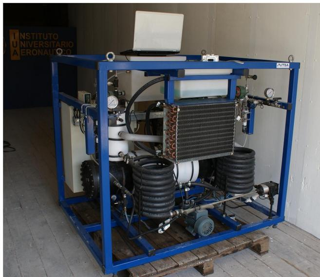
Figura 2: Electrolizador 5KW
