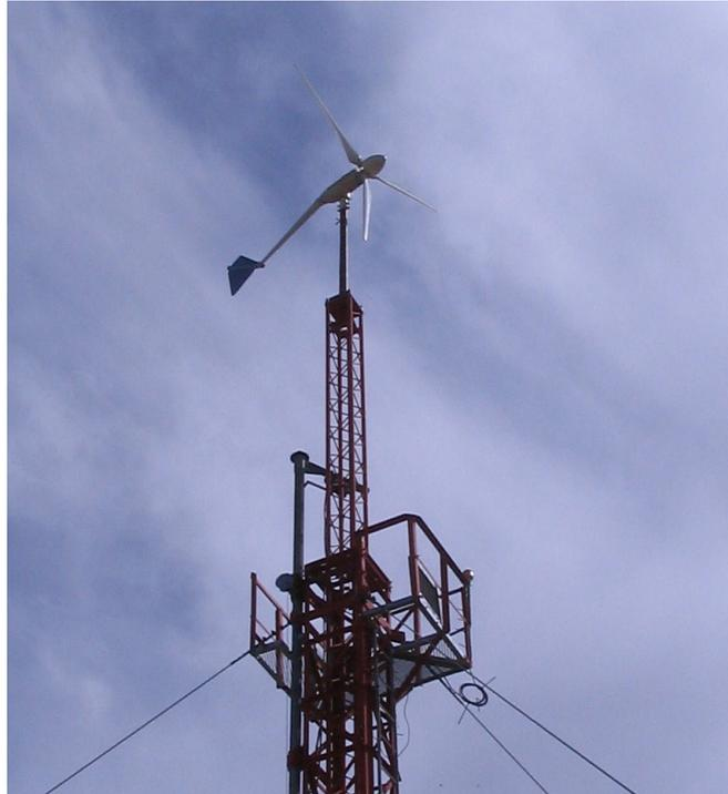
Figura 1: Aerogenerador 1.5KW
