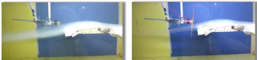
Figura 7: Visualizaciones con humo del flujo sobre el ala en vista lateral: derecha sin accionamiento del motor e izquierda con el motor en funcionamiento.
