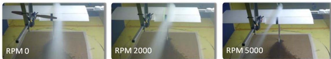
Figura 8: Visualizaciones con humo del flujo sobre el ala en vista posterior a distintas RPM.
