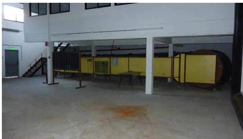
Figura 2: Túnel de Viento de Capa Límite TV1.
