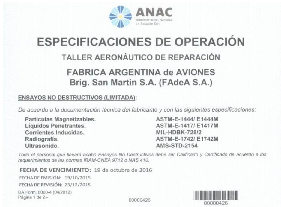
Figura 5: Especificaciones de operación de FAdeA. Puede verse que la ISO 9712 detallada es de energía nuclear.
