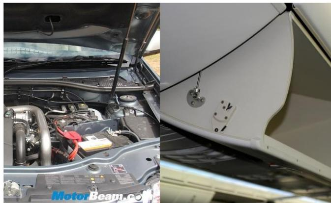
Figura 8: Actuador neumático del capot de un automóvil y un actuador de portaequipajes de avión..
