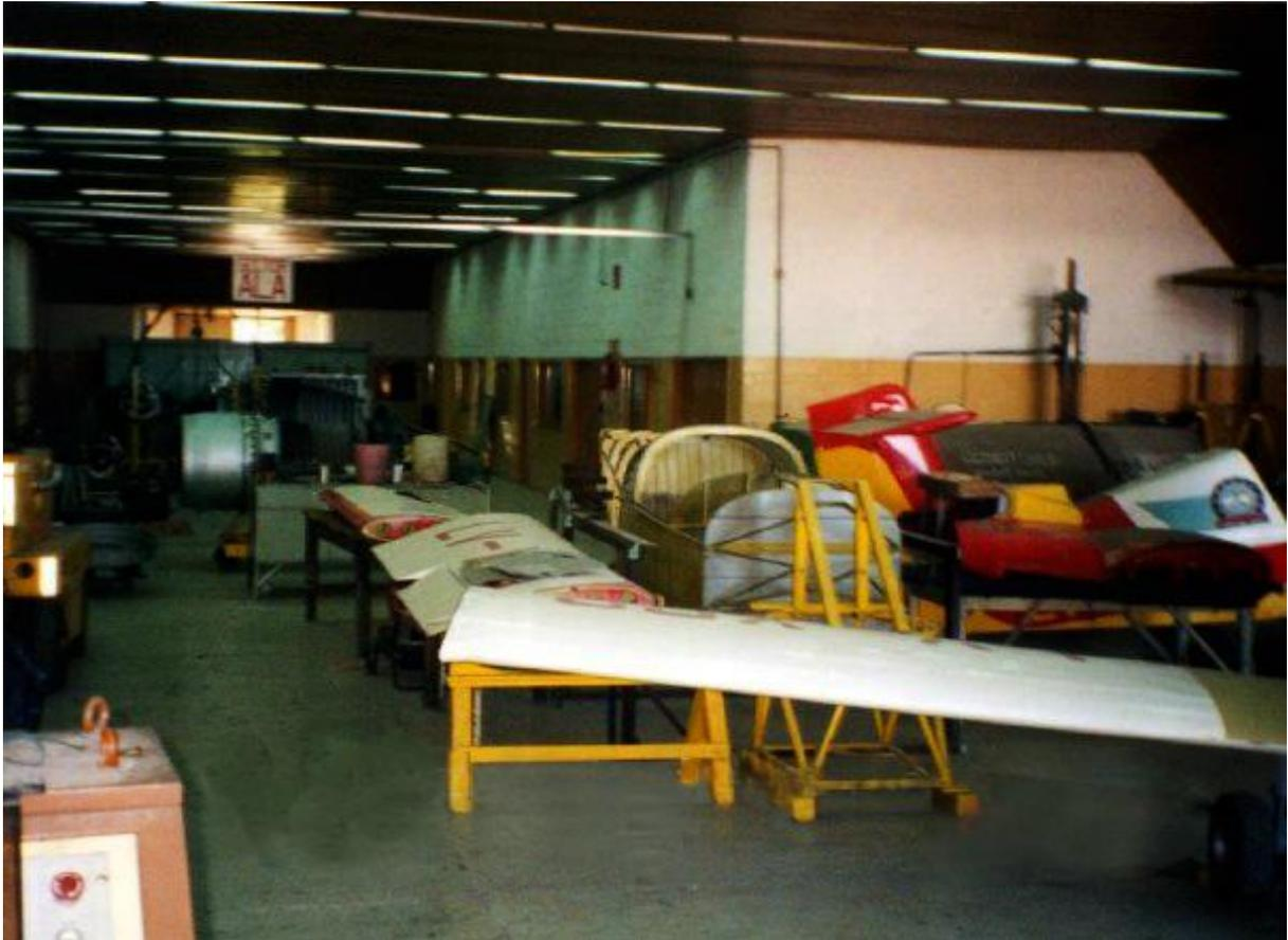
Figura 7: El PAZMANY PL-3 en construcción, el PL-4, espera al lado.
