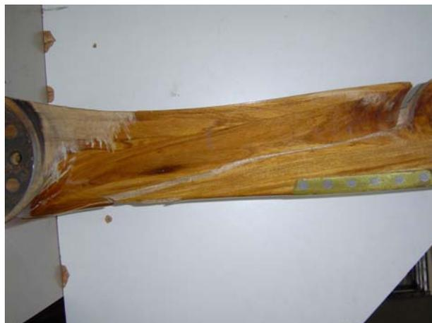
Figura 9: Vista de la fractura en la pala 1 desde el intrados
