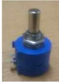
FIGURA 14 : Potenciómetro multivuelta Bourns
