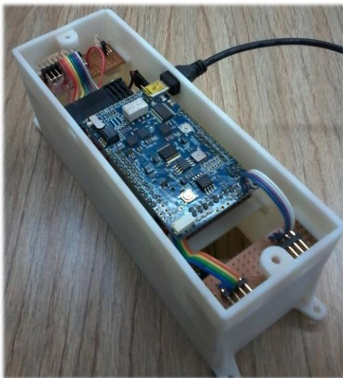
Figura 5 – Vista superior del autopiloto
