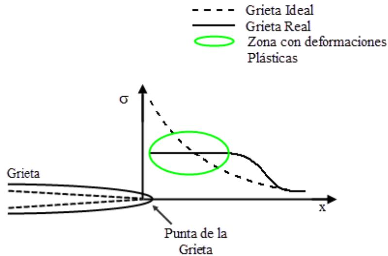
Figura [2.4] – Redistribución de Tensiones en el Punta de la Grieta y Zona Plástica
