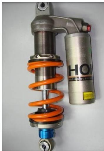
**Figura 7.2:** Amortiguador Hokun Mini Cross
