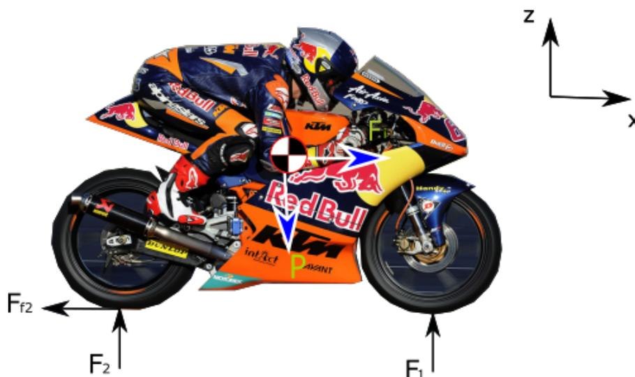
Figura 3.14: Diagrama fuerzas segundo caso de carga
