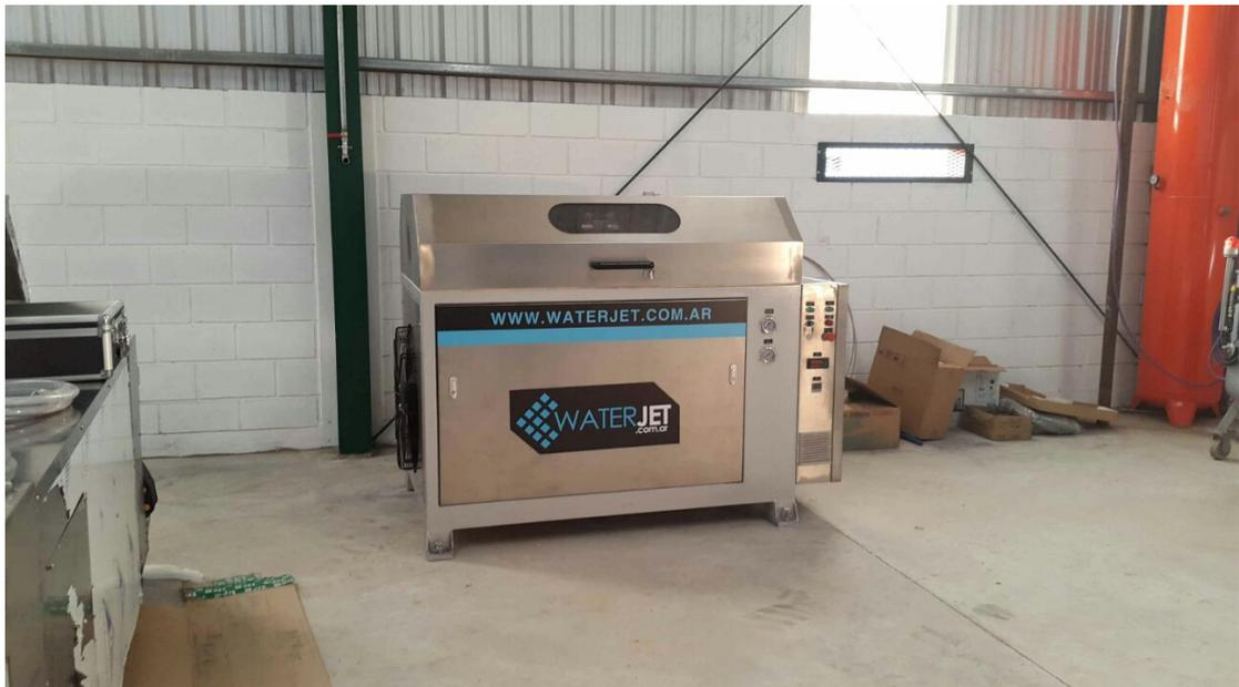
Máquina para corte mediante presión por chorro de agua
