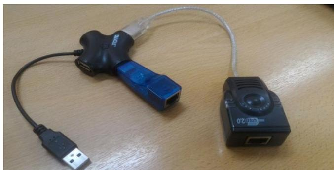
Ilustración 43: Adaptadores USB-Ethernet [Fuente: Propia]
