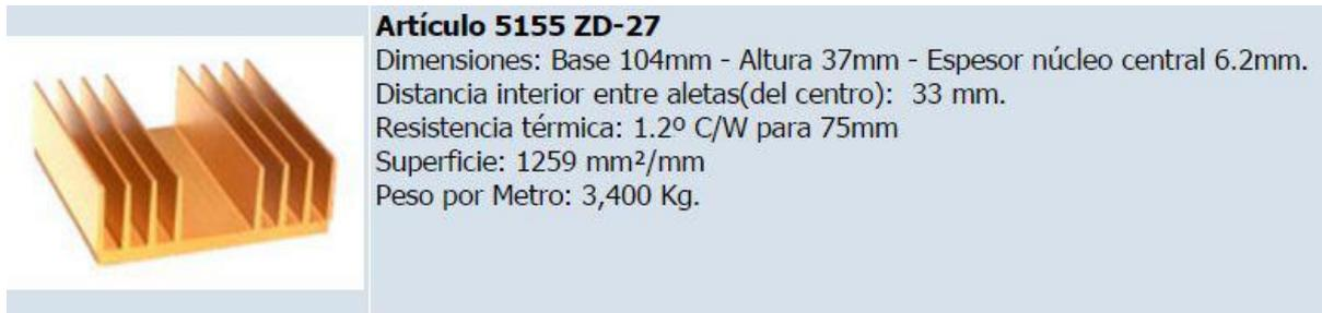
Figura 40. Características técnicas del disipador
