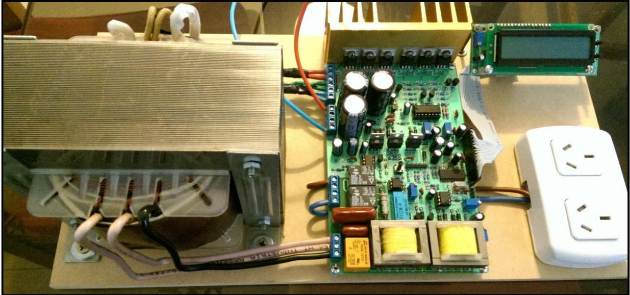
Figura 30. Montaje final y completo del Inversor de 1000W
