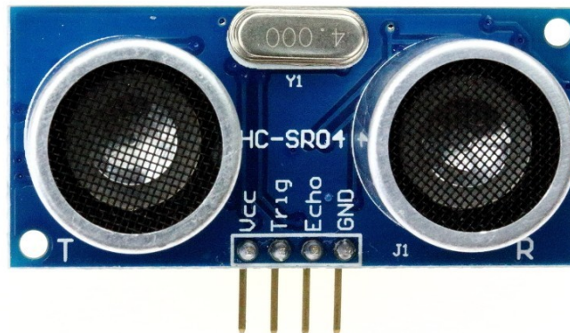
Sensor de distancias por Ultrasonido Micropik HC - SR04
