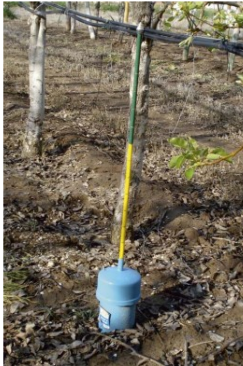
Freatímetro instalado en el suelo, el sistema de colores de la varilla permite estimar a simple vista el nivel freático
